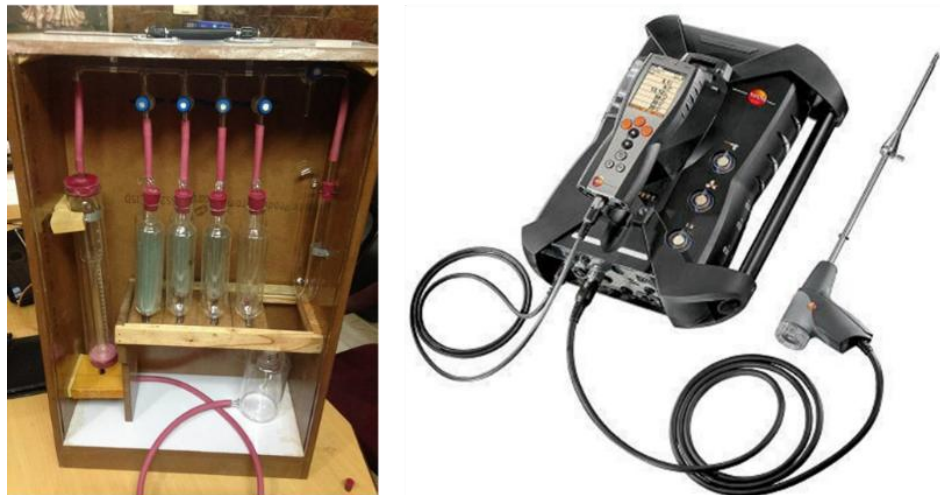
Ilustración 12: Dispositivos de medición para determinar la concentración de O 2 , CO 2 y CO
