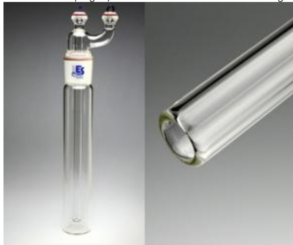
Ilustración 13: Impinger para determinar la humedad de los gases
